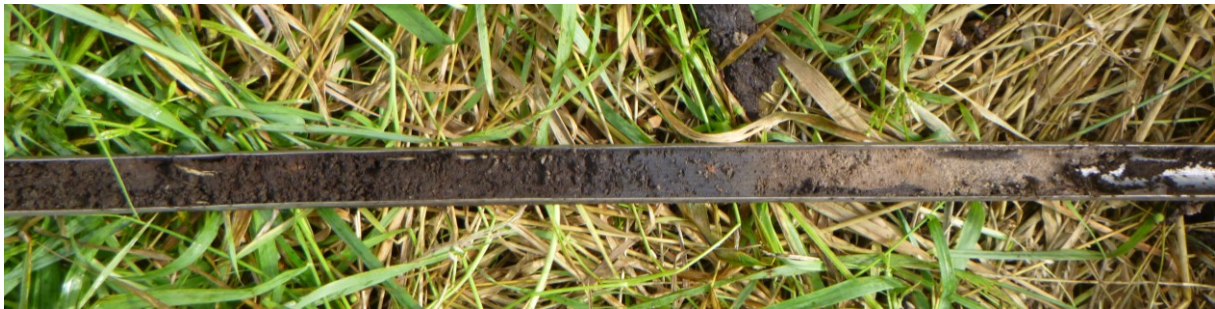
Figuur 24: Foto van de laag beekklei (donkergrijs; midden) zoals deze in de boringen 3 en 7 is aangetroffen tussen het veen (bruin; links) en het dekzand (geelgrijs; rechts).
