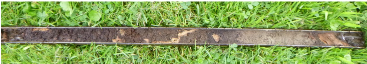
Figuur 23: Foto van het intacte veenpakket (links) zoals dat op veruit de meeste boorpunten is aangetroffen met onderin resten van bomen waarvan de wortels deels bewaard zijn gebleven in het onderliggende zand (rechts).
